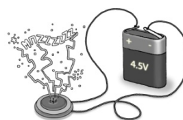
Σχήμα 9: Κύκλωμα μπαταρία, καλώδια, βομβητής
