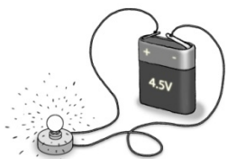
Σχήμα 8: Κύκλωμα μπαταρία, καλώδια, λάμπα
